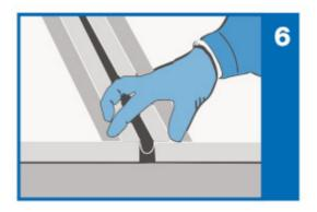
Stöße zwischen zwei **Mapeband TPE** Streifen müssen mittig mindestens 5 cm breit überlappend mit Heiß- oder Kaltverklebung wie oben beschrieben ausgeführt werden. Im Bereich von T- oder Kreuzfugen sind spezielle **Mapeband TPE T-** und **Mapeband TPE Cross**-Anschlüsse für 17 cm bzw. 32,5 cm Bandbreite zu verwenden.
