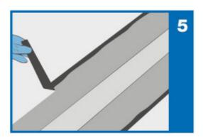
Beschädigungen (wie z.B. Perforationen) von **Mapeband TPE** während der Verarbeitung sind zu vermeiden. Bei größeren zu erwartenden Bewegungen muss **Mapeband TPE** (Bild 6) schlaufenförmig in der Fuge eingelegt werden.
