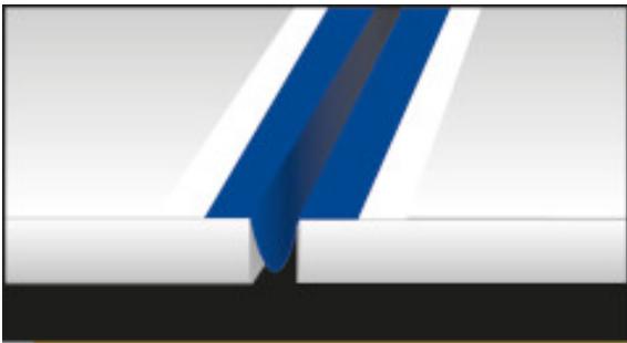
Schlaufenförmiges Einarbeiten von Mapeband im Dehnfugenbereich
