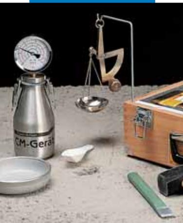
Feuchtigkeitsmessung nach dem CM-Verfahren
