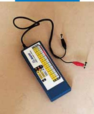
Feuchtigkeitsbestimmung mittels speziellem MAPEI-Messgerät
